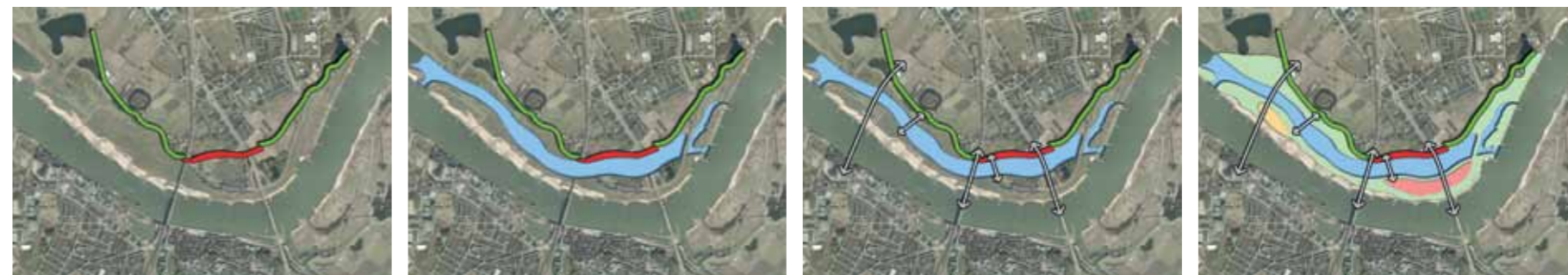
De maatregel bij Lent schematisch weergegeven op de luchtfoto, de dijk en kade, ruimte voor de geul, bruggen over de geul en het ontstaan van het schiereiland
