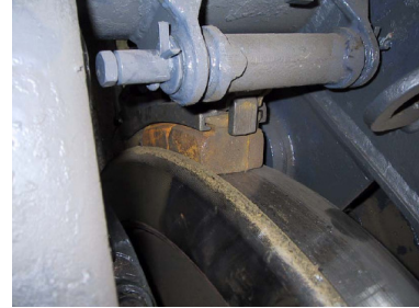
De oorzaak van het lawaai: Gietijzeren remblokken op stalen wielen
